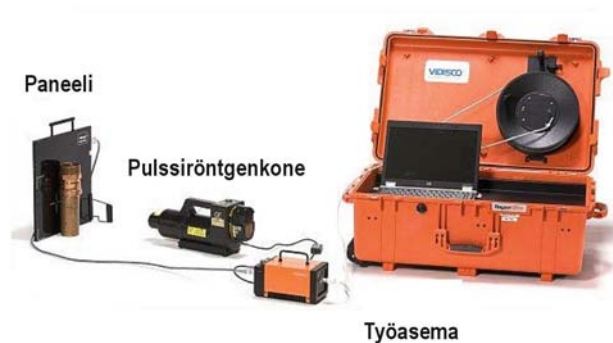
Kuva 47. Digitaalisen röntgenkuvauslaitteiston osat. (Lähde: www.vidisco.com )
