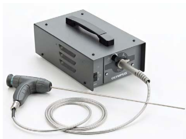
Kuva 40. Esimerkki endoskoopista. (Lähde: http://www.olympus-ims.com )
