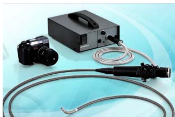
Kuva 39. Esimerkki fiberoskoopista (Lähde: http://www.olympus-ims.com )
