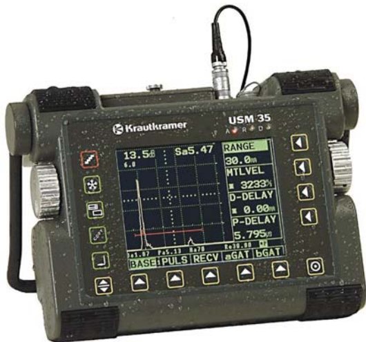
Kuva 43. Krautkrämerin A-kuvallinen ultraäänilaitteisto. (Lähde www.ge-mcs.com )
