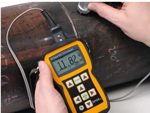
Kuva 44. Krautkrämerin paksuusmittari. (Lähde www.ge-mcs.com )
