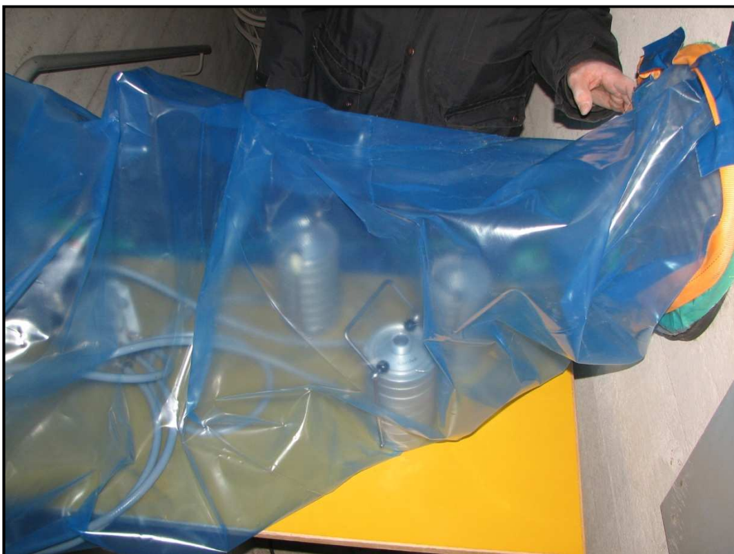
Kuva 38. Ryömintätilaisen alapohjan ilmanäytteen koejärjestely.
