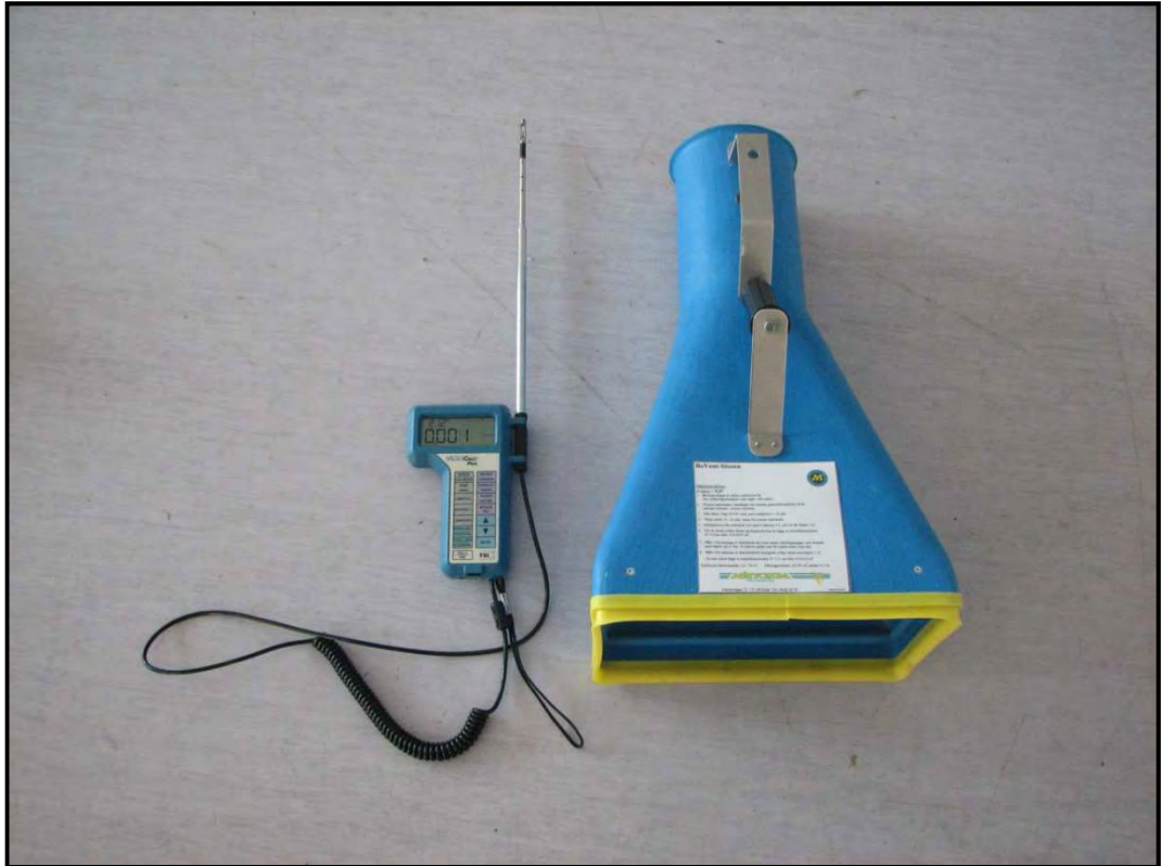
Kuva 34. Ilmastointimittari ja anemometritorvi.
