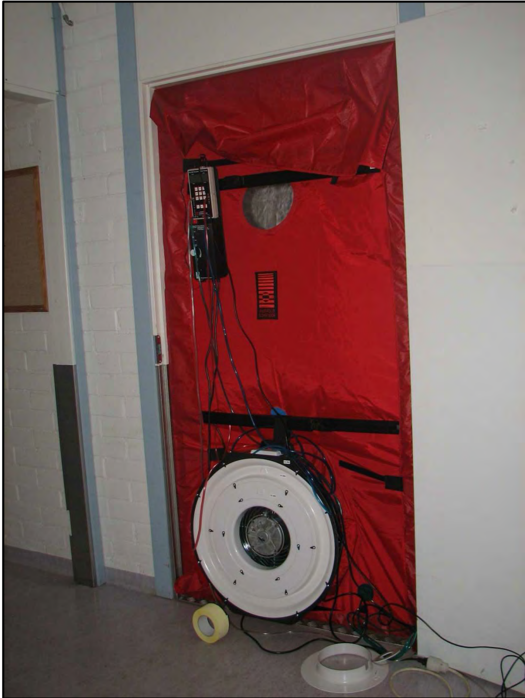
Kuva 36. Blowerdoor Basic-laite asennettuna huoneiston pääoveen.
