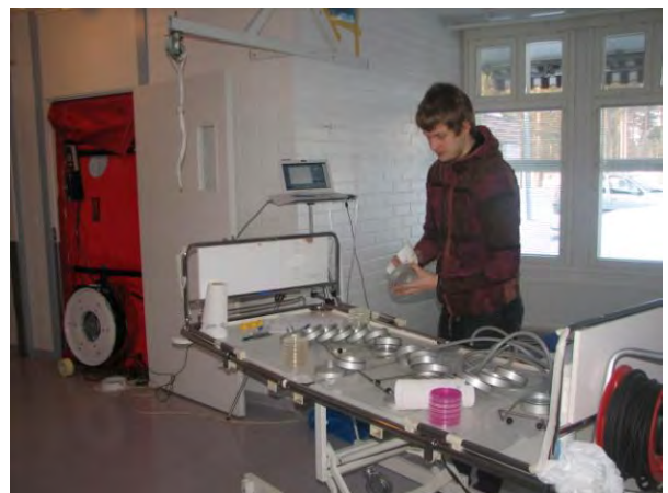
Andersen-keräimen desinfiointi käynnissä huoneessa D. Taustalla ilmanpitävyyssmittauslaite alipaineistamassa.
