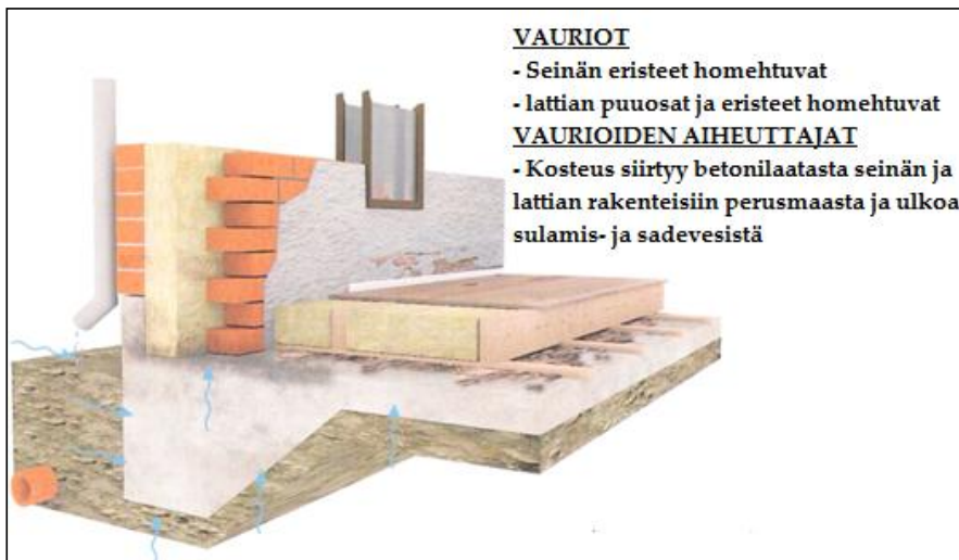
Kuva 8. Reunavahvistettu laatta ja puukorokelattia
