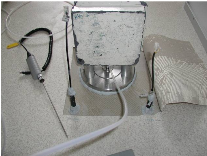
Kuva 26. FLEC-mittaus betonirakenteen pinnasta päällysteen poistamisen jälkeen. (Järnström H., 2012)
